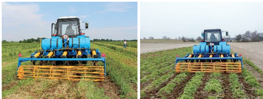
Фото 2. Глубокорыхлитель «ГЧ4», оборудованный системой подачи ЖГУ.
