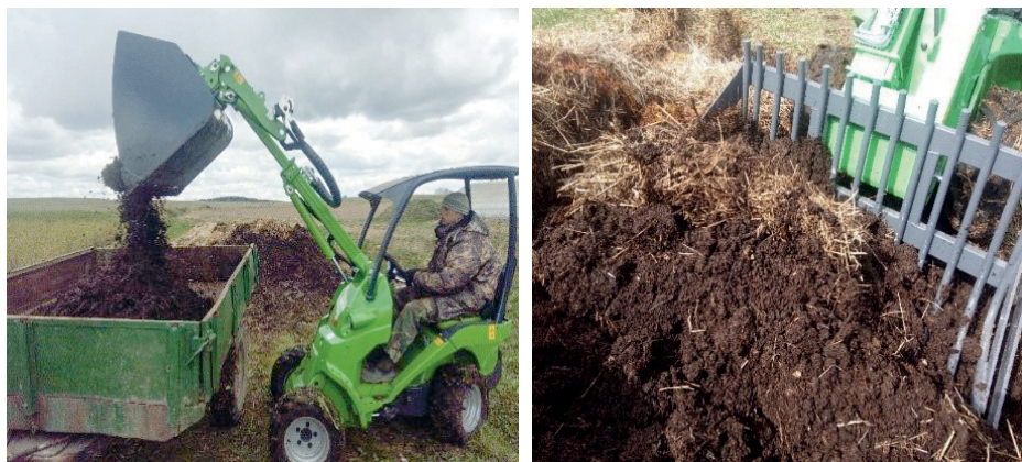
Фото 6. Минипогрузчик «Авант 528» с навесным оборудованием используется для ворошения и перемещения компоста.
